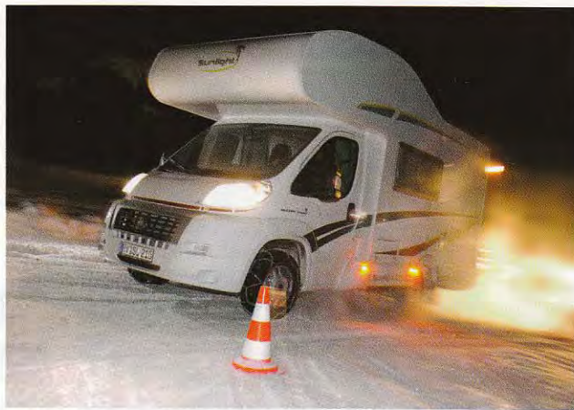
Maximales Kurventempo: Auf schneebedeckter Kreisbahn wird die Seitenführung ermittelt. Mit Ketten kann das Mobil übersteuern.
